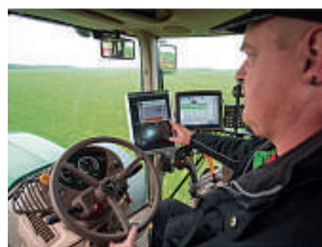
Der Rugged Computer Compact 8 ist für den Dauereinsatz in harscher Umgebung oder für den Ausseneinsatz konzipiert
