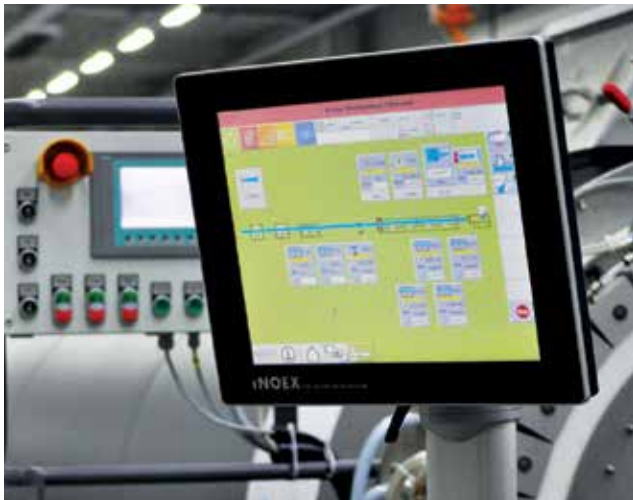
Das HMI-System, das Inoex für ihre Anlagen nutzt, stammt aus der Projektiv-Kapazitiv-Touch-Panels-Serie von Syslogic. Das integrierte CPU-Board basiert auf dem Intel-Atom-E3845-Prozessor.
