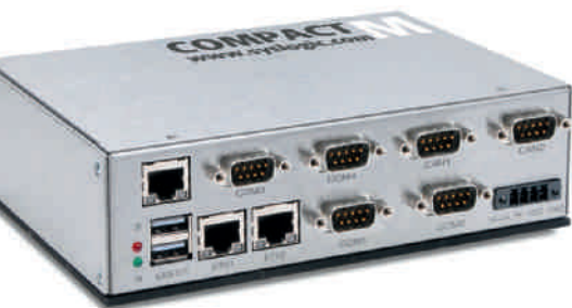
Der Embedded PC der Compact M Serie.
