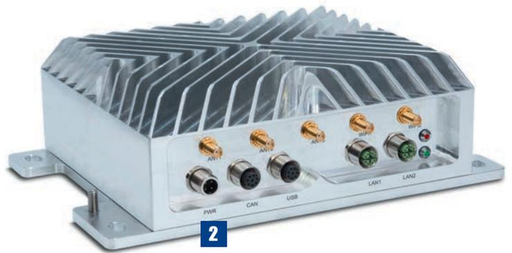
[1-3] In den KI-fähigen Embedded-Systemen von Syslogic kommen aktuell die Prozessorplattformen Jetson TX2 und Jetson AGX Xavier von Nvidia zum Einsatz. Die Boards fertigt das Unternehmen selbst.
