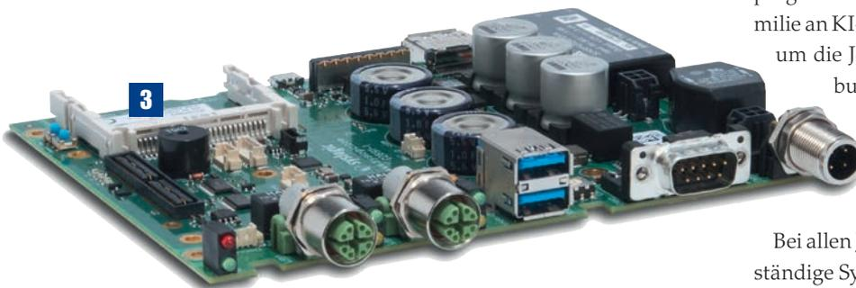
rieren zudem PMIC (Power Management IC), DRAM (Arbeitsspeicher) und Flashspeicher. Mit der parallelen Prozessorstruktur eignen sich die Plattformen ideal, um die Software autonomer Maschinen schnell und energieeffizient auszuführen. Entsprechend lassen sich mit den Modulen KI und Edge-Computing kombinieren.
